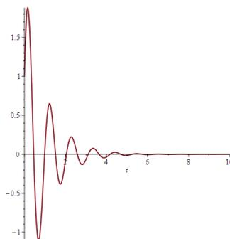
Abbildung 29: Schwingung mit schwacher Dämpfung
