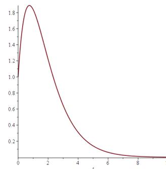
Abbildung 30: Grenzfall zwischen schwacher und starker Dämpfung
