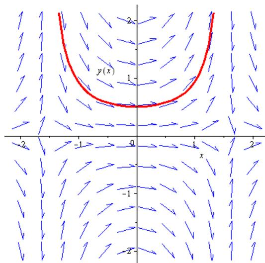
Abbildung 27: Richtungsfeld von  $y' = y \cdot \tan x$  mit partikulärer Lösung zu  $y(0) = \frac{1}{2}$
