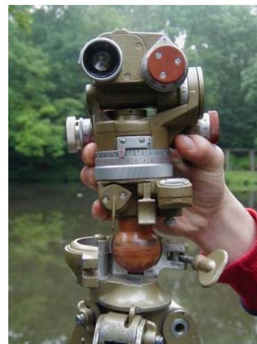
Abb.8.2 Befestigen der Bussole auf dem Stativ
