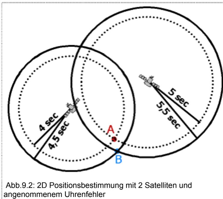
Abb.9.2: 2D Positionsbestimmung mit 2 Satelliten und angenommenem Uhrenfehler
