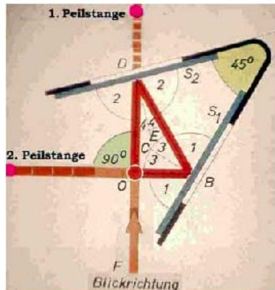
Abb.6.3.: Strahlengang an einem Winkelspiegel
