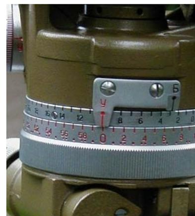
Anschließend wird der zweite Fluchtstab angepeilt. Jetzt kann der Winkel zwischen den beiden angepeilten Punkten an der Bussole abgelesen werden.
