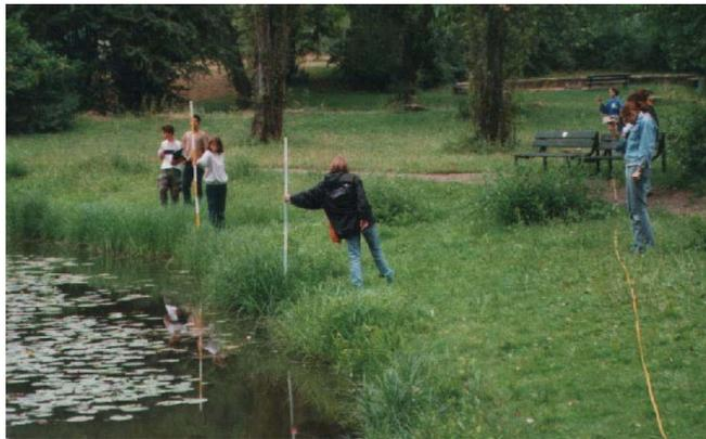
dem Maßband vor und zurück, bis sie einen  $90^\circ$ -Winkel zwischen sich, der Messlatte des Assistenten und der Messlatte im Nullpunkt feststellen. Das heißt ein Vermesser liefert dem Protokollanten die X-Werte für die Messpunkte und der andere die dazugehörigen Y-Werte. Diese ermittelten Punkte lassen sich nun leicht in ein geeignetes kartesisches Koordinatensystem übertragen. (Siehe Abbildung 6.6)
