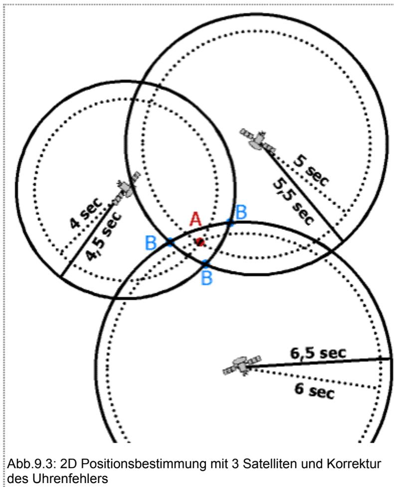
Abb.9.3: 2D Positionsbestimmung mit 3 Satelliten und Korrektur des Uhrenfehlers
