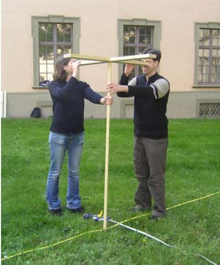
Abb. 5.2: Das Drehkreuz mit Stativstab.
